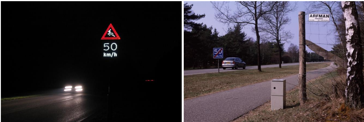
Figuur 20 Dynamische waarschuwingsborden lichten op na detectie van een dier in de wegberm (links) bij een 200 m brede wildsluis op de Veluwe (rechts). Foto's: Marcel Huijser.
