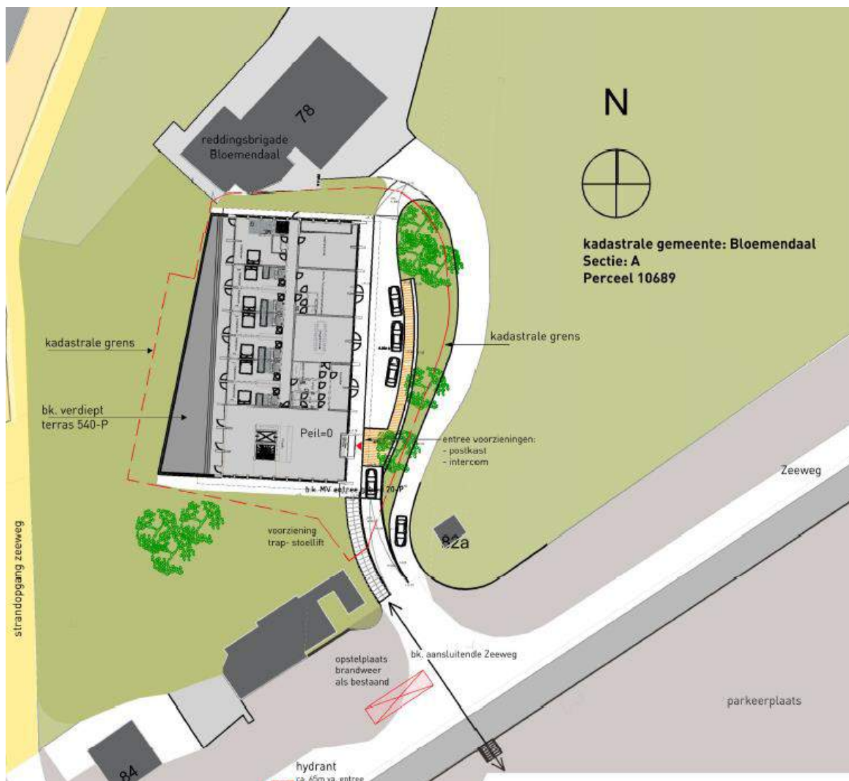
Figuur 9: situatietekening toekomstige situatie op begane grondniveau, incl. ontsluiting (bron: Buro Bol)
